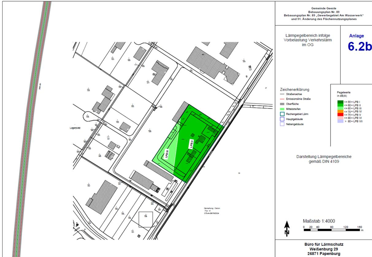
**Abbildung 7: Lärmpegelbereiche II bis III (Anlage 6.2b (= ungünstigster Fall 1. OG) (Jacobs 2024)**
